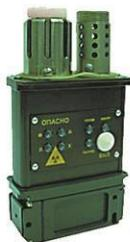
Предназначен для обнаружения в воздухе паров специальных веществ и сильнодействующих ядовитых веществ (СДЯВ) — хлора, аммиака и др.
