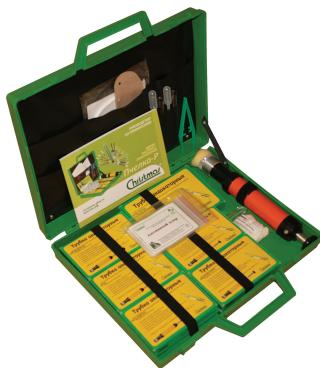
Комплектная мини-экспресс-лаборатория «Пчелка-Р» (далее – «Пчелка-Р») предназначена для экспресс-контроля химической загрязненности объектов окружающей среды (воздуха и промышленных газовых выбросов, воды, почвы, сыпучих сред и продуктов питания) с применением индикаторных трубок и тест-систем.
