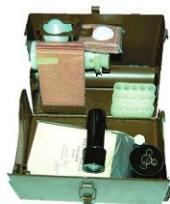
Предназначен для определения в воздухе, на местности и на технике ОВ — зарина, зомана, иприта, фосгена, дифосгена, синильной кислоты, хлорциана, а также паров V-газов в воздухе.
